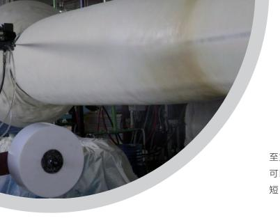
**喷涂**生产尤其适用于中到大直径的管道,以及常规 至重量级管道。旋转喷涂保温管道具备经济优势,因为 可以使用较薄的外壳,并且更改管道直径时设置时间更 短,可提高生产效率。
